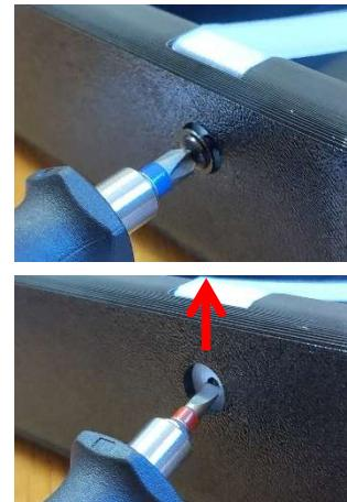
Die neue Spange wird einfach vorn vorn hinein gedrückt und dann von unten verschraubt.
